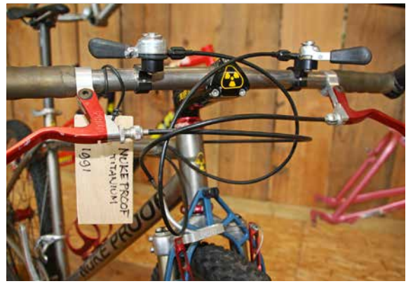
▲ De titanium Nuke Proof. De shifters zijn in feite gewoon buiscommandeurs van een racefiets
