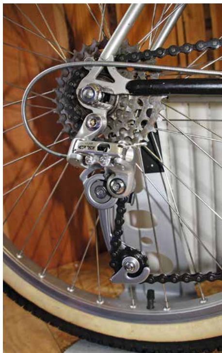
▲ Derailleur op de eerste Stumpjumper uit 1982. Let op het extra scharnierpunt
