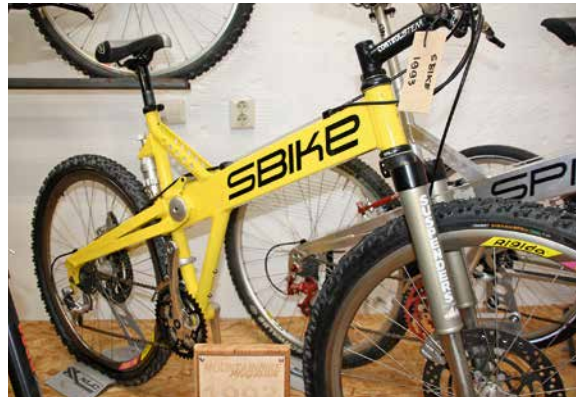
▲ Sbike uit 1993 met experimenteel frame, achtervering en upside down suspension
