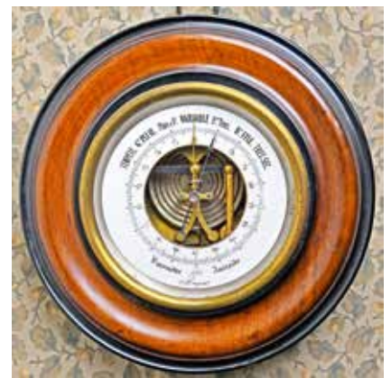
Aneroïde barometer met het voor Breguet karakteristieke mechaniek zichtbaar. Circa 1865. Gesigneerd LCB en Breguet, serienummer 3618. Doorsnede 27,5 cm.
