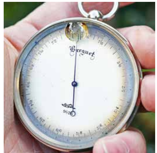
Aneroid barometer van Breguet op zakhorlogeformaat. Circa 1870. Gesigeneerd LCBr en Breguet, serienummer 9626. Op het draaibare frontglas is een lensje aangebracht dat nauwkeurige aflezing mogelijk maakt. Doorsnede 61 mm.
