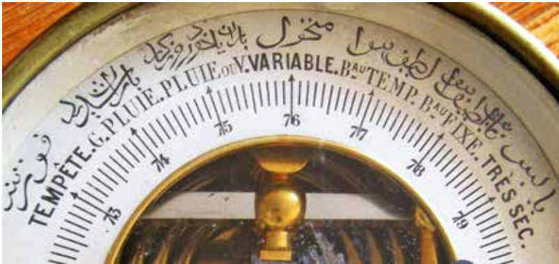
Schaalplaat van een aneroïde barometer van Breguet met weeraanduidingen in het Frans en het Arabisch. Circa 1865. Serienummer 7386.
