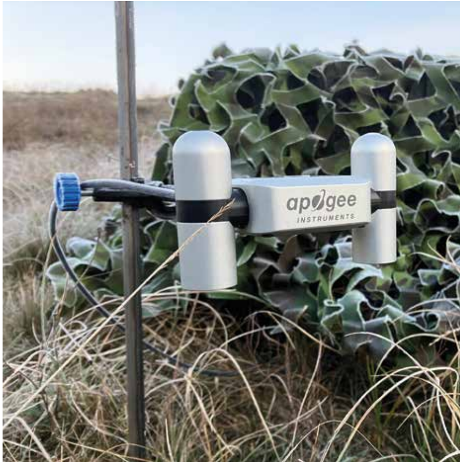
Stralingsmeters in Bol 2. in combinatie met metingen van windverstoreningen en luchtvochtigheid is de netto straling maatgevend of de koudepoel in de duinpan afkoelt of juist opwarmt. Het camouflagenet hangt over een thermobox waarin zich de dataloggers bevinden die de gemeten waardes opslaan.
