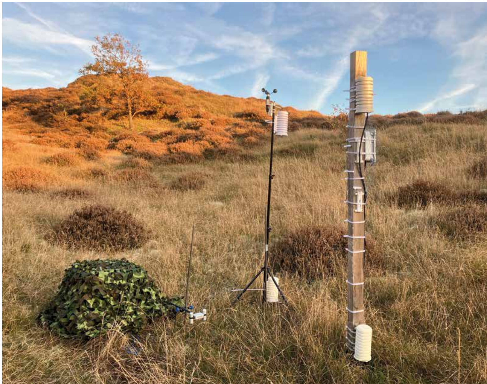
De meetopstelling in duinpan Bol 2. Weerhutjes met temperatuursensoren hangen op 10 en 150 cm hoogte. Op de rechterpaal hangt de datalogger die de metingen via internet doorgeeft. Op de linkerpaal wordt ook de luchtvochtigheid gemeten en hangt een windmeter die het effect van windverstoring op de koudepoel in de duinpan meet.
